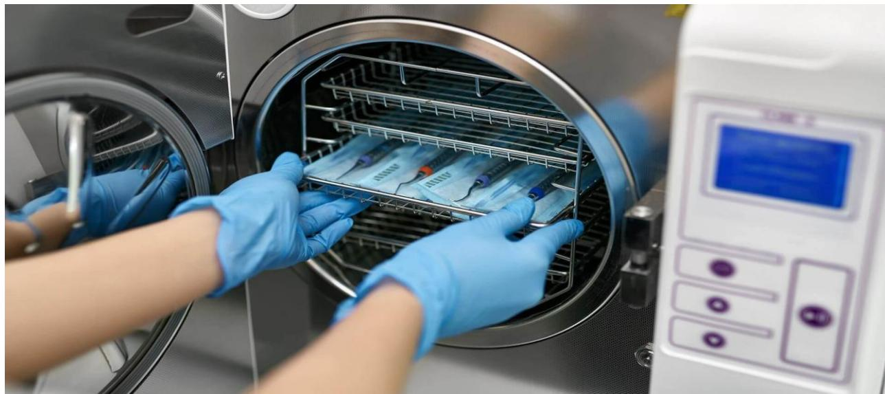
A esterilização por autoclave utiliza vapor de água sob alta pressão e temperatura para matar microorganismos patogênicos. As autoclaves operam, normalmente, a temperaturas entre 121°C e 134°C, com ciclos variando de 15 a 60 minutos, dependendo do material a ser esterilizado.
